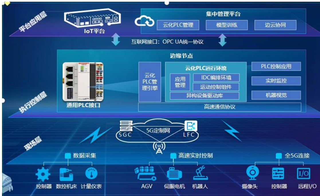
图 55 基于 5G 云边协同的工业控制操作系统（云化 PLC）
