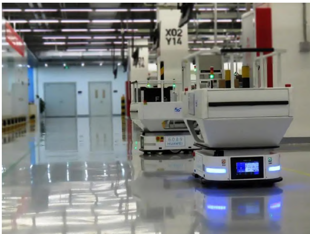
图 52 华为松山湖南方工厂 AGV 小车实现园区自动化配送
