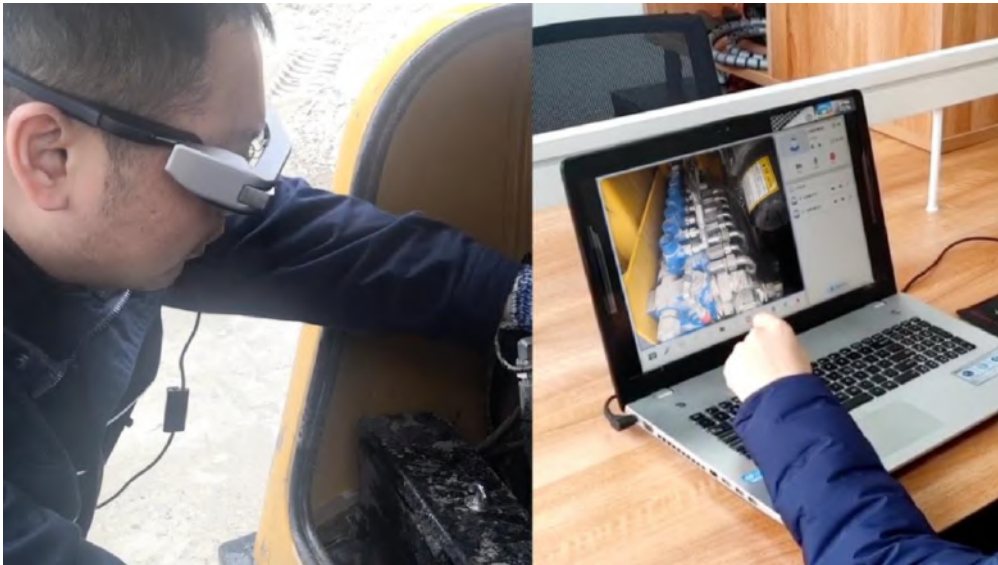
图 34 通过“工业 AR 远程协助系统”，一位技术专家可以在后方通过大屏幕，指导千里之外的人员维修设备
